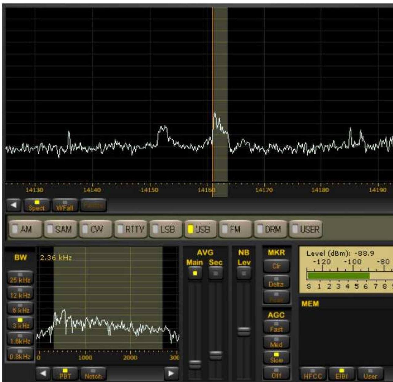
Aiguille cadran en mode "spectre" en conjonction avec les réglages du volet BW
